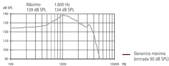
UltraPower BTE con pila de tamaño 675 y micrófono omnidireccional.
