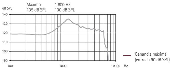
SuperPower BTE con pila de tamaño 13 y micrófono omnidireccional.
